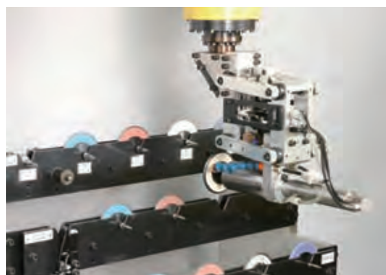
ホイールツールホルダーとツール自動交換装置
