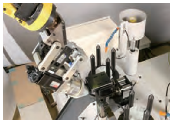
ディスクツールホルダーとディスクペーパー自動交換装置
