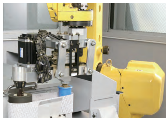
ベルトサンダーツールホルダーとサンディングベルト自動交換装置
